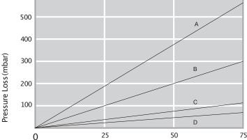
10" B-Blue Flow Rates (lt/min) A=0.5 - 1µm B=5/10µm C=20/30µm D=50µm+
